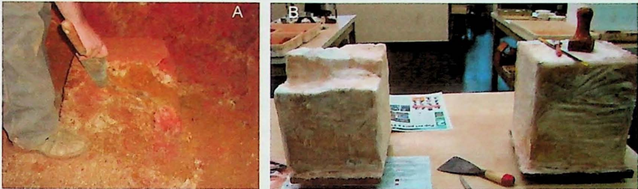
Figura 21 – Bloco indeformado durante talhagem em campo (A), Blocos indeformados revestidos por parafina (B). Foto B: Laboratório de solos da EPUSP
