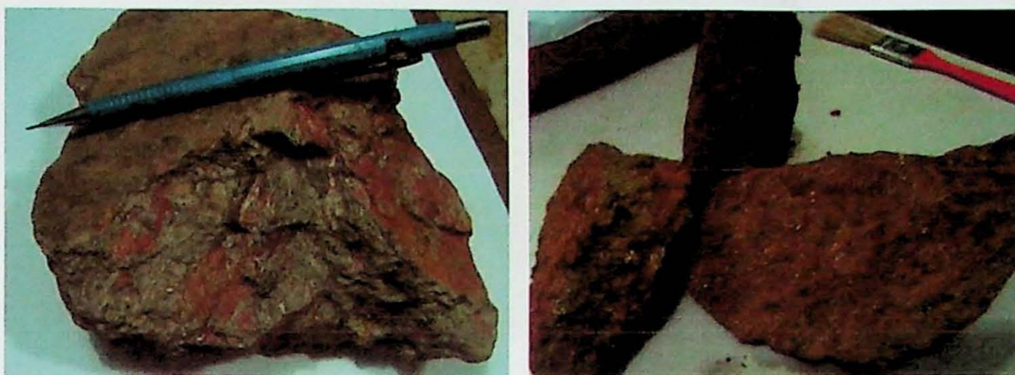
Figura 07- Xisto / mica xisto aflorantes nos pontos GRM-05 e GRM-01 respectivamente, ilustrando a variação textural e mineralógica e a xistosidade bem definida.
