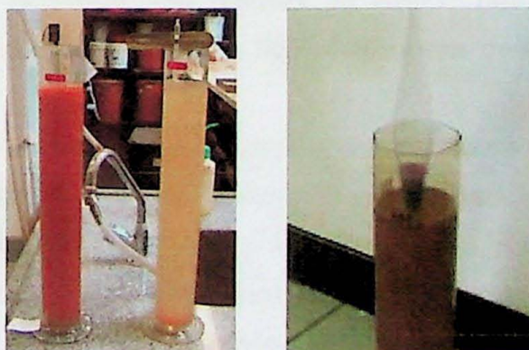
Figura 24 – Materiais utilizados no ensaio de sedimentação: (A) provetas graduadas, termômetro e (B) densímetro. Fotos: Laboratório de solos da EPUSP
