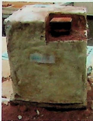
Figura 27 – Anel metálico durante talhagem de corpo de prova, em bloco de amostra indeformada.
