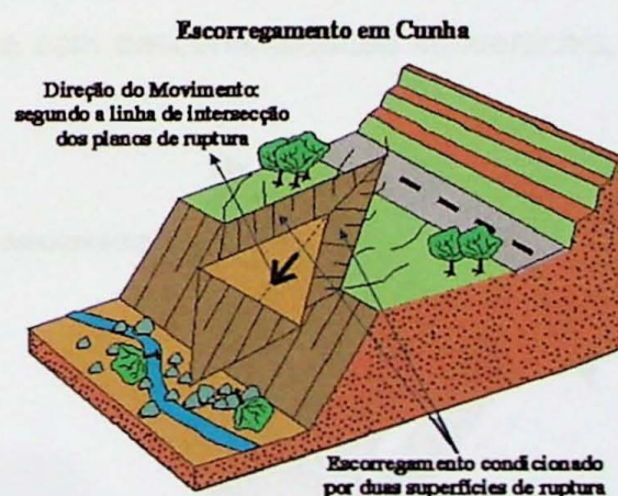
Figura 15 – Escorregamento em cunha. Retirado de http://www.rc.unesp.br/igce/aplicada/ead/interacao/inter09d.html
